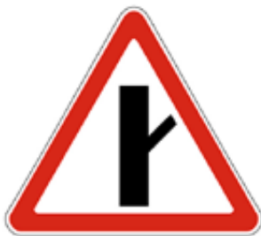
2.3.4 Примыкание второстепенной дороги справа
