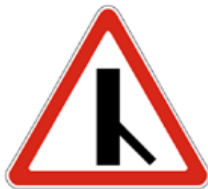
2.3.6 Примыкание второстепенной дороги справа
