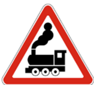
1.2 Железнодорожный переезд без шлагбаума
